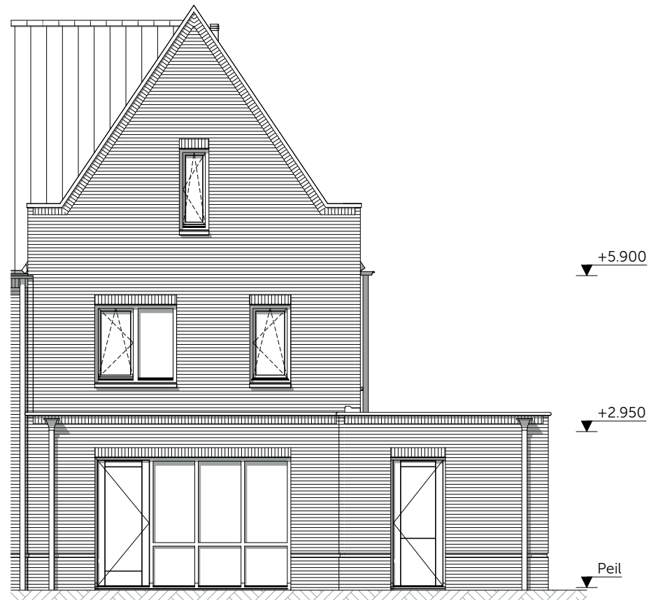
Achtergevel schaal 1:100 - Uitbouw 1,2m aan de achtergevel
