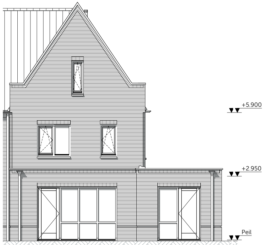
Achtergevel schaal 1:100 - Uitbouw 1,2m aan de achtergevel i.c.m. werkkamer
