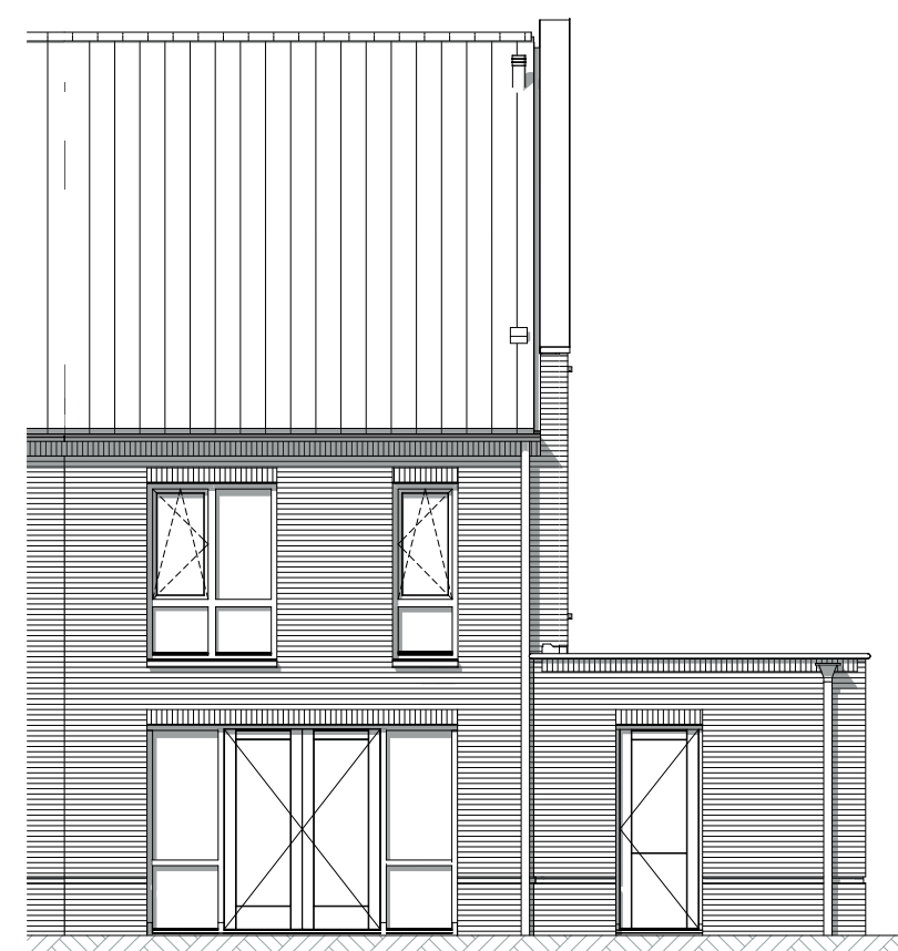
Achtergevel schaal 1:100 - Pui met dubbele deuren in de achtergevel
